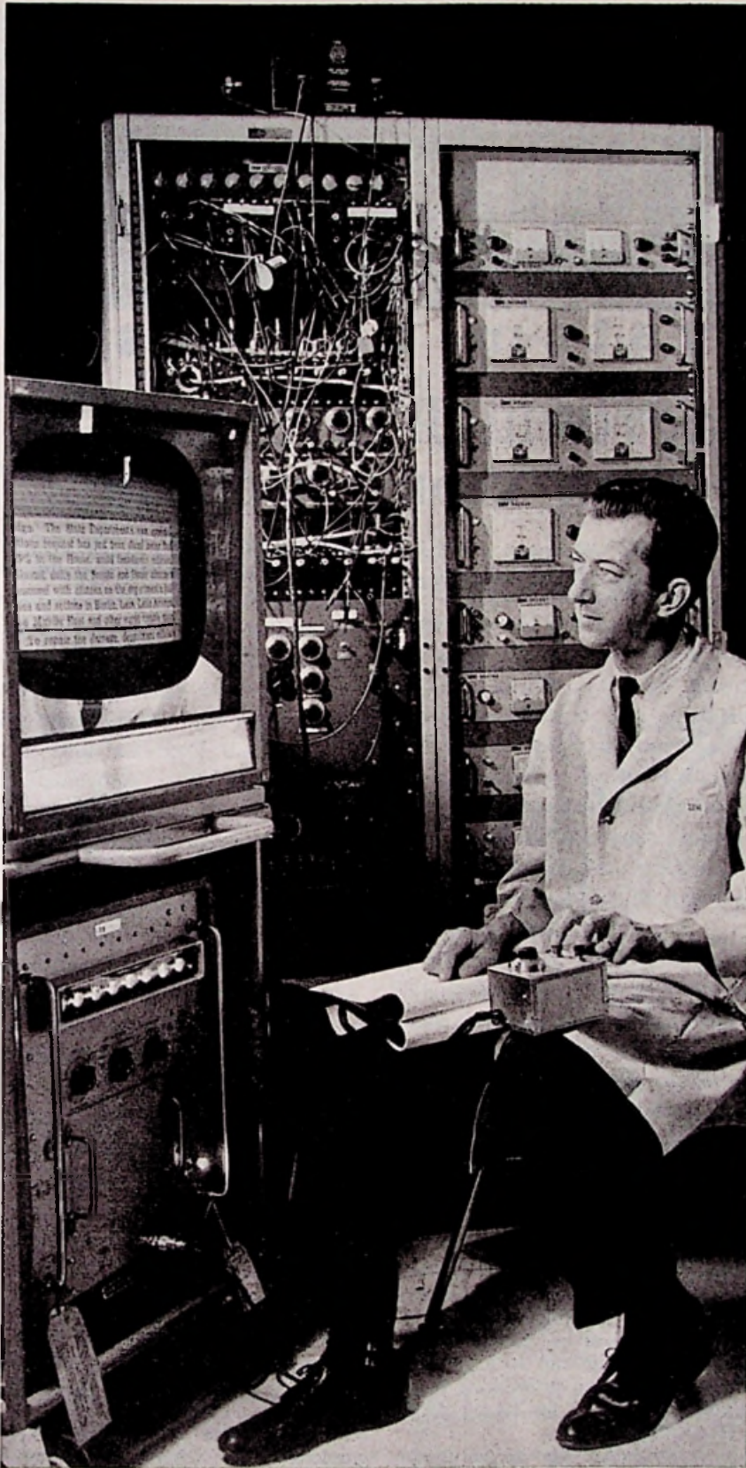
2. Een gedeelte van de apparatuur van de optische tekenlezer voor verschillende typen tekens van IBM. De voeding en opnemer op de achtergrond, een gedeelte van het meetgeheugen is rechts te zien. Links het televisiescherm waarop de tekst, die door de opnemer gelezen wordt, ter controle verschijnt.
